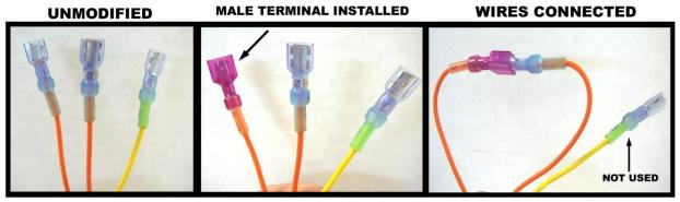
**SENDING UNIT WIRES FOR SINGLE FUEL TANK**
